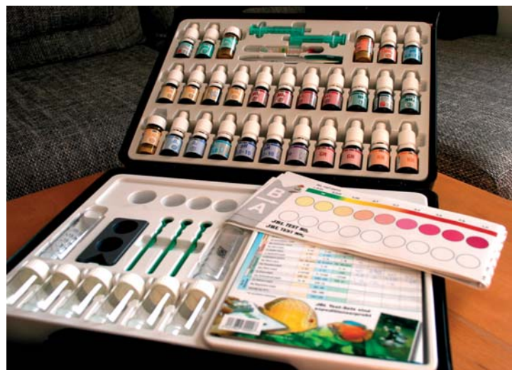
Abb. 2. Die Wasserwerte im Aquarium lassen sich mit einem Set wie diesem bestimmen.
