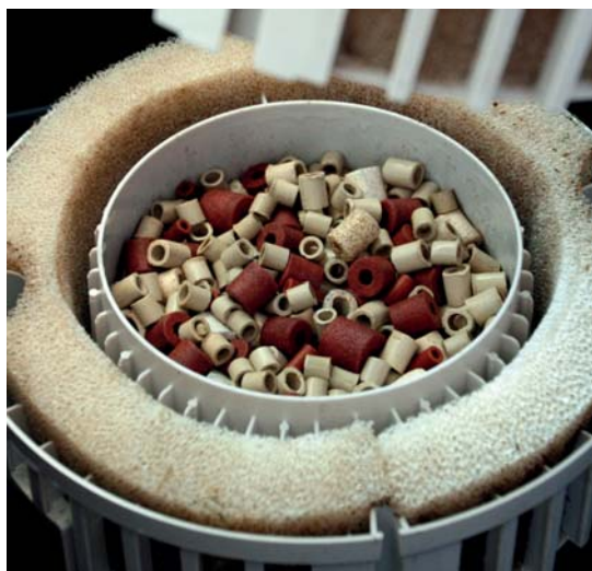
Abb. 1. Der biologische Filter für ein 600-Liter-Aquarium, hier ein Gefäß außerhalb des Behälters mit Keramikröhrchen als Filtermaterial.
