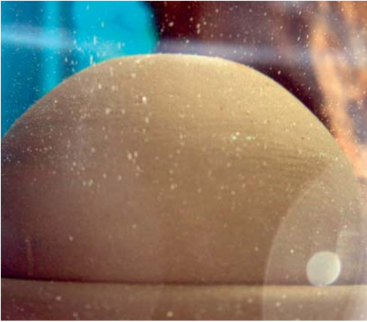
Abb. 3. Bringt Sauerstoff ins Wasser: der Söchtung-Oxydator. In dem Tongefäß zersetzt ein Mangandioxidkatalysator Wasserstoffperoxid kontinuierlich zu Wasser und Sauerstoff, der dann aus dem Gefäß perlt.
