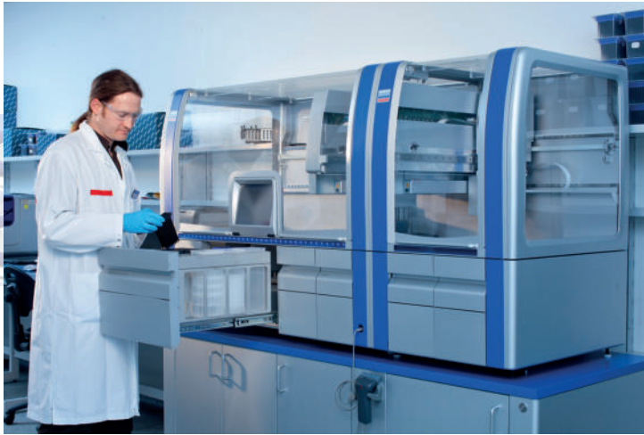
All-Inclusive-Geräte führen den gesamten PCR-Test vollautomatisch durch, mitsamt Extraktion und Säuberung der Nukleinsäure. Foto: Qiagen
