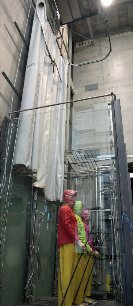
Regenturm an der Empa: Funktionstextilien im Belastungstest (zehn Meter Fallhöhe und verschiedene Regenarten). Foto: Empa
