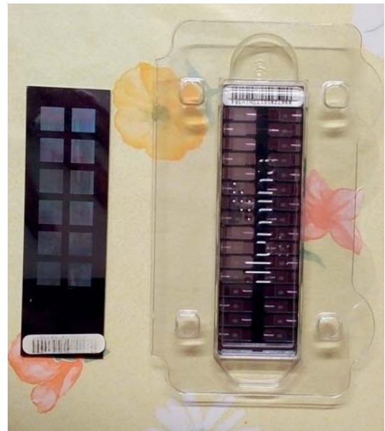
SNP-Chip, der zeigt, welche Erbgut-Variationen ein Schwein hat (Einzelnukleotid-Polymorphismus, single nucleotide polymorphism, SNP). Er analysiert insgesamt 60000 Genorte.
